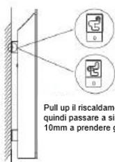
Smonta la stufa dal muro
